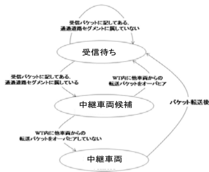
図 3 Road-Segment-Based Data Dissemination の受信車両の状態遷移
