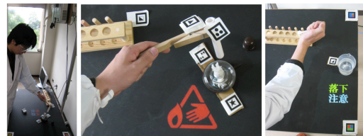
図7 視覚マーカーを用いた作業認識と物体付近への情報提示
