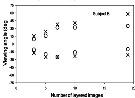
図 B-2-2 DFD 表示を適用した視域角の例 (○ : 検出限界, × : 許容限界)
