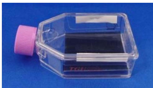
写真1 培養フラスコを利用した簡易霧箱
