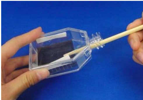
写真7 OHP シートの広げ方
