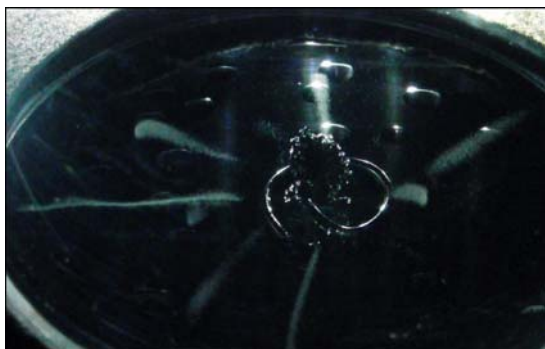
写真11 霧箱で観察できた \alpha 線の飛跡
