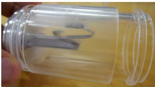
図6：周波数可変リード式音源の例
