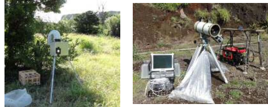
図 1 DOAS 光源装置 (左図) と DOAS 受光装置 (右図)
