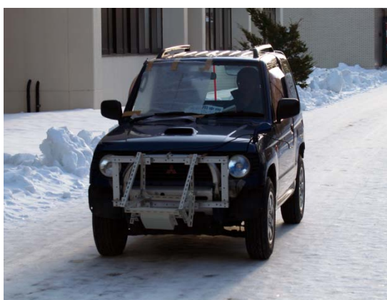
図 8 発泡梱包材を張って走行実験(1 アンテナ)
