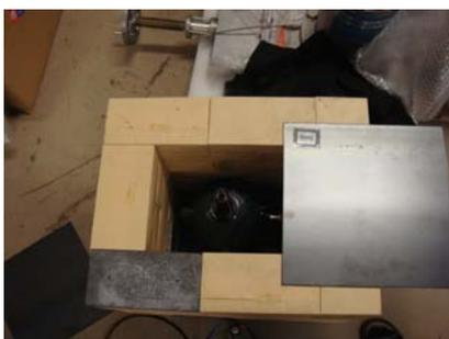
図5 鉛ブロックで作られた遮蔽体。その内部に積分球及び検出器を設置した。
