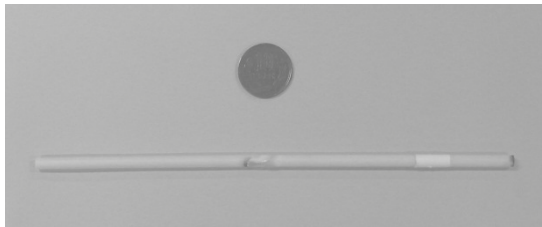
図3. セラミックパイプの突合せ溶接の例 (a)装置の断面構造 (b)突合せ溶接したアルミナパイプ (5mmφ) 上は大きさの比較のための10円玉
