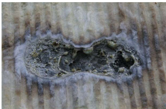
図8. 放電後のロックウールの状態
