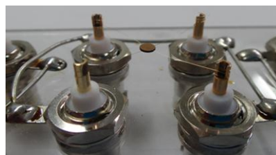
図3. 交流インピーダンス用疑似 4 端子イオン伝導測定用試料の写真
