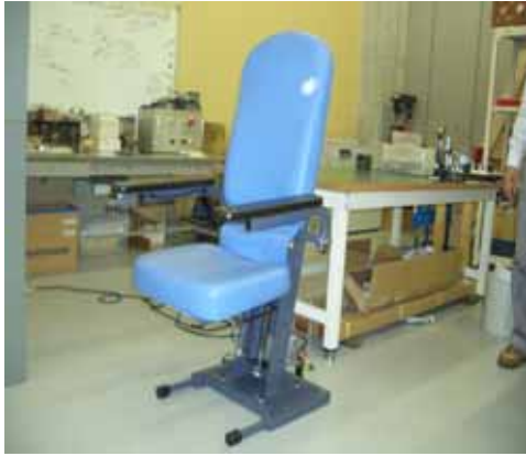
図5 立ち上がり補助座椅子の完成品（総重量 588N）
