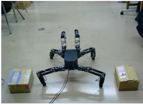
図8 水平4脚2腕モードにおける4脚歩行
