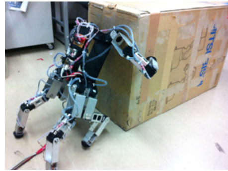
図10 垂直4脚2腕モードによる大型物体の押し搬送
