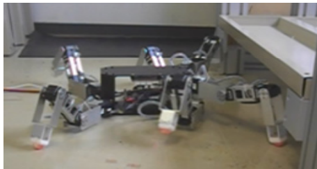
図4 天井の低い隙間への進入
