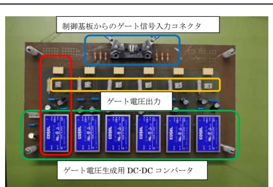
図 2 ゲートドライブ回路
