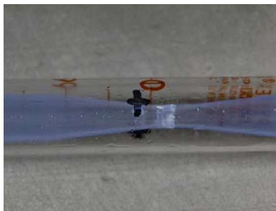
図3 キャビテーション発生部の拡大写真
