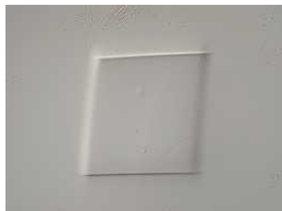
図3 ホール効果測定用サンプル (一辺が約 400 ミクロン)
