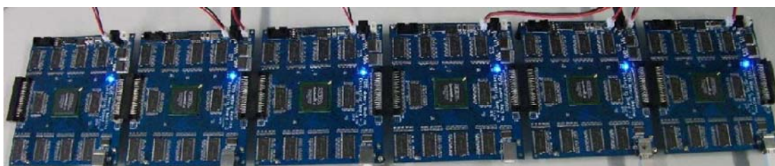
図7 並列処理用FDTD専用計算機による6マシン並列処理システム
