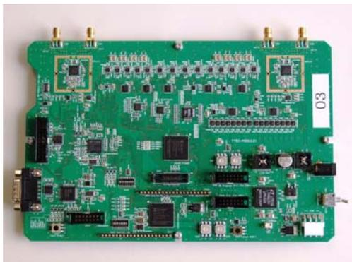
図 9: RF 波形解析装置の構成と写真
