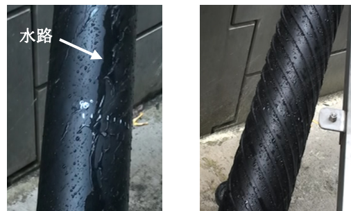
円断面ケーブル スパイラル突起付ケーブル
