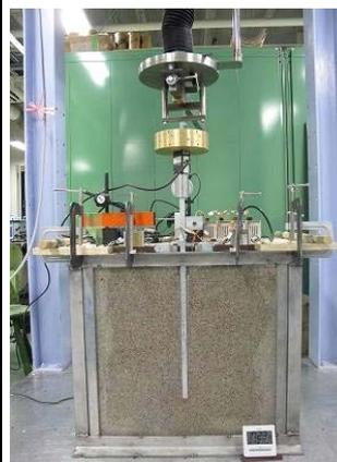
図 1 小型模型土槽
