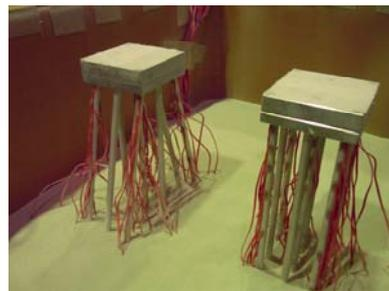
写真3 斜杭基礎(左)と直杭基礎(右)の模型
