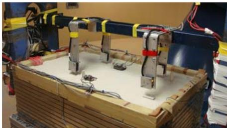
写真1 遠心振動実験の試験体外観
