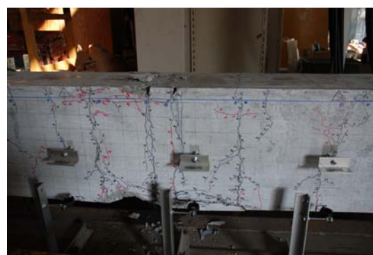
写真 2 PRC 梁の二点曲げ載荷実験 (実験終了後)
