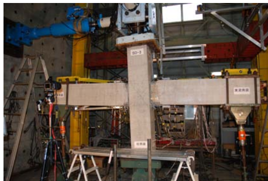
写真 1 十字形 PRC 柱梁部分骨組の実験
