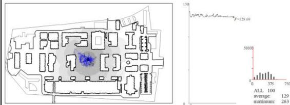
図 4-1 近似解 設置台数 1 台 障害付距離 129m(平均)
