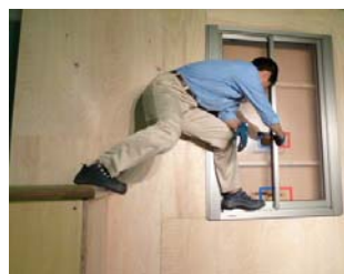
写真4 バルコニーから侵入する方法の検証（バルコニーを跨ぐ方法や腰をかける方法など様々検討した）
