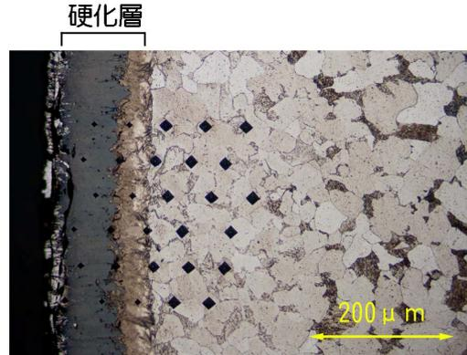
図4 窒化熱処理後の丸棒の断面組織
