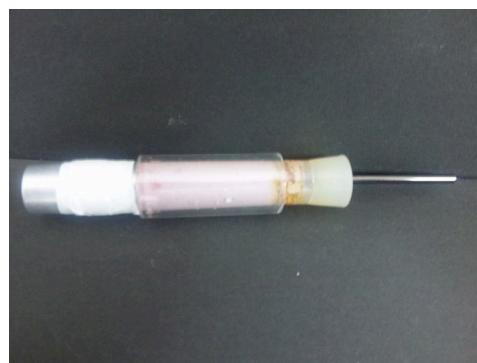
図3 カラム型色素増感太陽電池モデル
