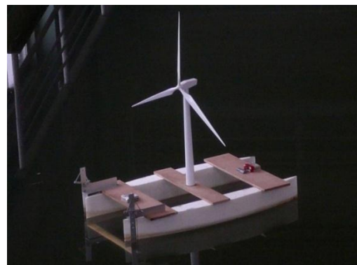
写真1 想定実機の1/50縮尺模型
