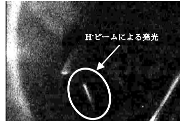
図6 H + ビームによるアルミナ蛍光板の発光発光の様子を示す。
