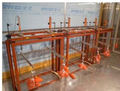
図1 長期継続荷重載荷試験の様子
