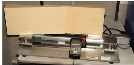
図1 並進型楔形レンジ変調器(WRS)の概略図
