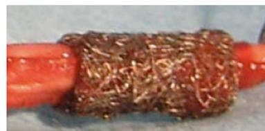
図 2. 膝蓋腱を挿入した円筒形チタン細繊維
