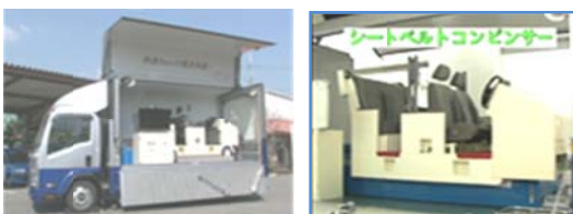
写真1 時速約5kmの低速度衝突体験装置 (シートベルトコンビンサー)
