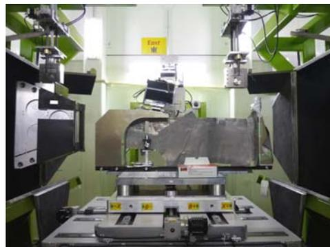
図 5. J-PARC センター物質・生命科学実験施設 BL19 へ設置した結晶アナライザーユニット及び治具の様子。紙面奥からパルス中性子ビームが入射し、バナジウムロッド試料により散乱される。散乱中性子のうち、波長 6.6 Å の中性子が紙面右手 (散乱角は 90 度) の結晶アナライザーユニットにより Bragg 反射 (Bragg 角は 80 度) され、紙面中央の 2 次元検出器により検出される。
