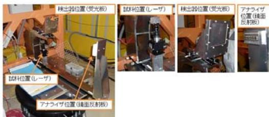
図 3. ビーム実験に先立ち行ったレーザ光源を用いた「試料」-「アナライザー」-「検出器」の設置位置確認実験の様子。
