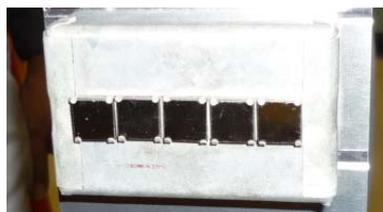
図 4. 結晶アナライザーユニット試験体。1 段に 5 枚の焼結グラファイト (PG) の結晶 (12mm 角) が設置されている。
