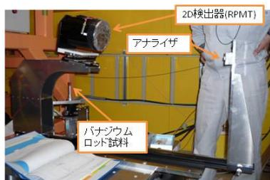
図 2. 時間・空間同時集光型アナライザーユニット試験体とその設置治具を含めた全体写真。
