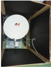
図 1 : アンテナとその周囲の電波吸収材
