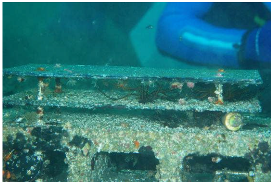
図 2 水深 20 m に設置した人工付着基盤（設置 8 ヶ月後）
