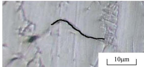
図12 き裂周辺エッチング画像および最小き裂の模式図
