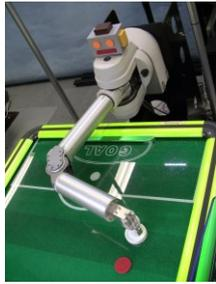
図10 エアホッケーロボットシステム
