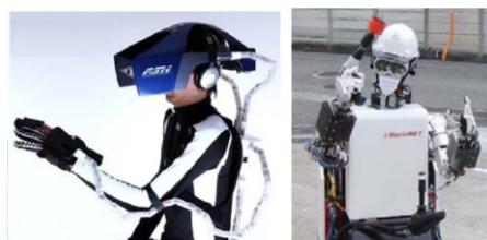
図9 (左)操作マスタ(右)スレーブロボット
