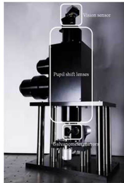
図5 Full-HD対応サッカードミラー。左に出ている2つの突起はモニター接続用のポートであり、同時に3台のカメラが同じ映像を取得できる。
