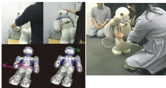
図1：3軸柔軟触覚センサを備えた小型ヒューマノイドロボット
