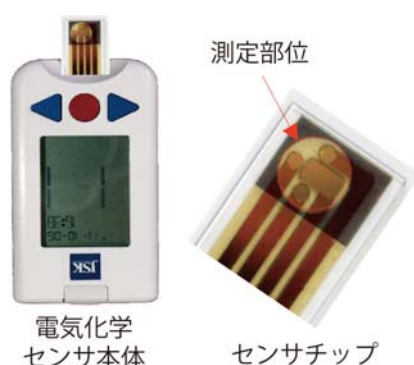
図5 本研究により開発した電気化学センサ
