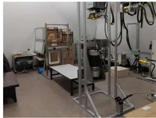
図5 X線管球と検出器用の専用固定具
