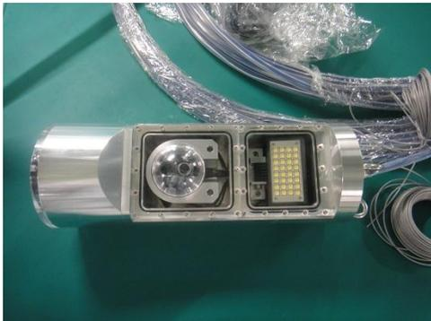
図3 開発したモニターカメラ。正面と下面にwebカメラ、正面上にLED照明を設置している。
