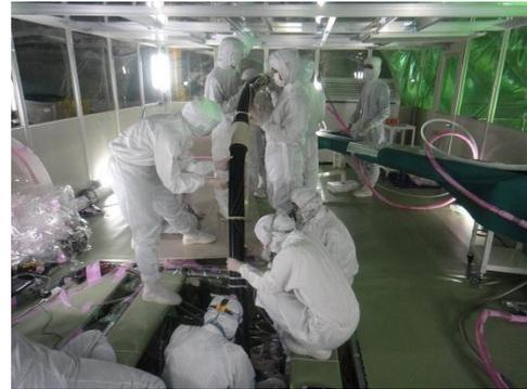
図4 ミニバルーンのカムランド検出器への設置作業の様子
