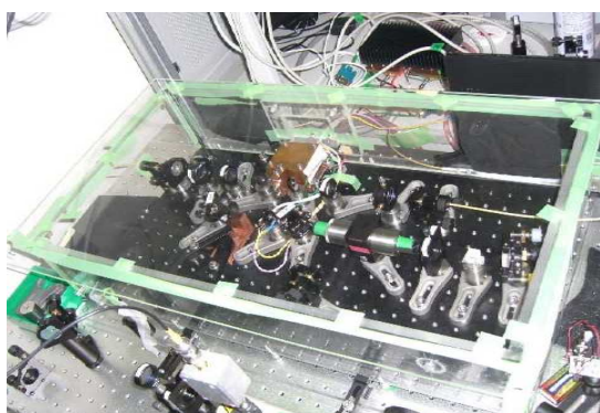
図 2 : 作成した半導体励起固体(DPSS)レーザー 単一縦モードで発振波長は 1064nm、得られた
