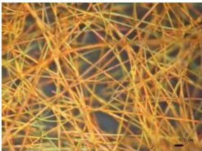
そこで、我々が開発して来たフラーレンナノファイバー (上図) を用いたナノ構造体の太陽電池への展開を検討した。フラーレンファイバーは液-液界面析出法を用いることで非常に簡便に合成可能である。フラーレンファイバーは高い結晶性を有するため、このファイバーを Electron transport の経路とすることで高い移動度が期待できる。また、化学修飾や物理吸着によりファイバー表面を電子ドナー分子により修飾することで機能性フラーレンナノファイバーを合成する。このようにドナー分子とフラーレンナノファイバーを近接させることで電荷分離の効率化を図った。
