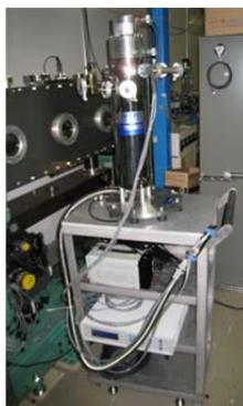
図 1. Cryo Industry 社製低温ガス吹付装置
