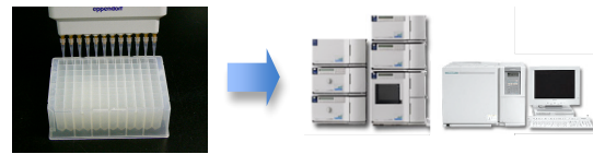
図1 担子菌 P450 の機能スクリーニングシステム 各々P450 を 96-well プレートで発現させ、基質を加えて微生物変換を行う。変換産物を HPLC や GC-MS を用いて分析する。
