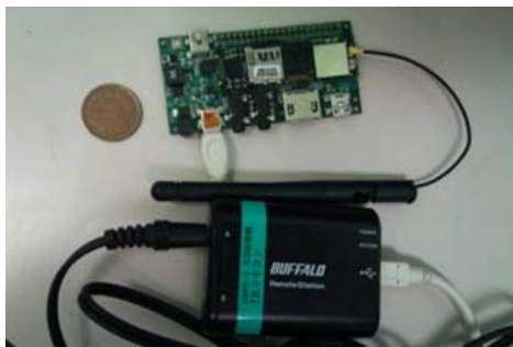
図 4 小型プロキシシステムの実装 (上が Overo ボード, 下は赤外線ユニット)
