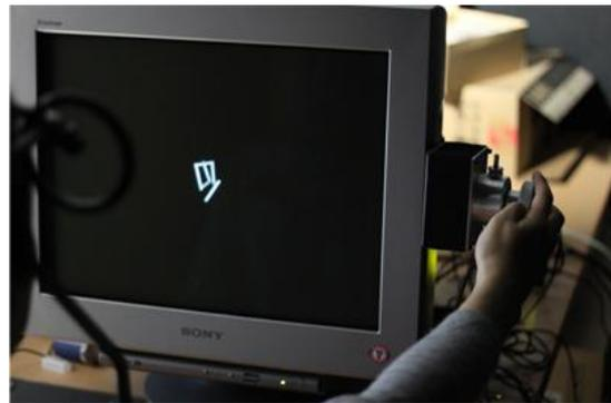
図 1. CRT ディスプレイ側面に取り付けられた回転デバイス。被験者はこれを手で操作することにより、CRT ディスプレイに呈示された物体を回転させた。
