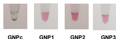
図 5. 各 dsDNA-GNP の 1 M \text{NaNO}_3 溶液中 (pH 7.4) における分散安定性
