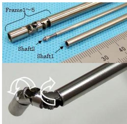
図 5：直径 5mm の 2 自由度マニピュレータ試作機
