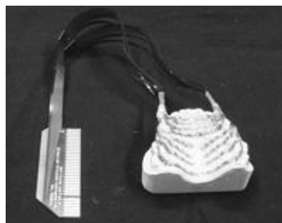
図4 舌接触検知電極付きの人工口蓋板
