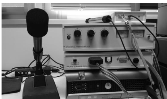
図1 英国製の動的パラトグラフィシステム (左側はマイク、右側最下段はパソコン)
